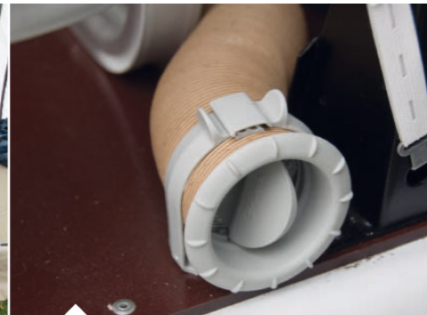
De ringverwarming loopt rondom de slaapcabine
